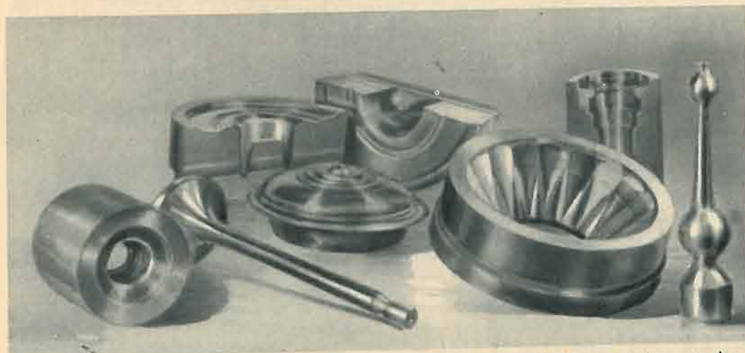
● Grazie al tasto, è infinita la varietà dei pezzi che possono essere lavorati da un tornio per copiare.
