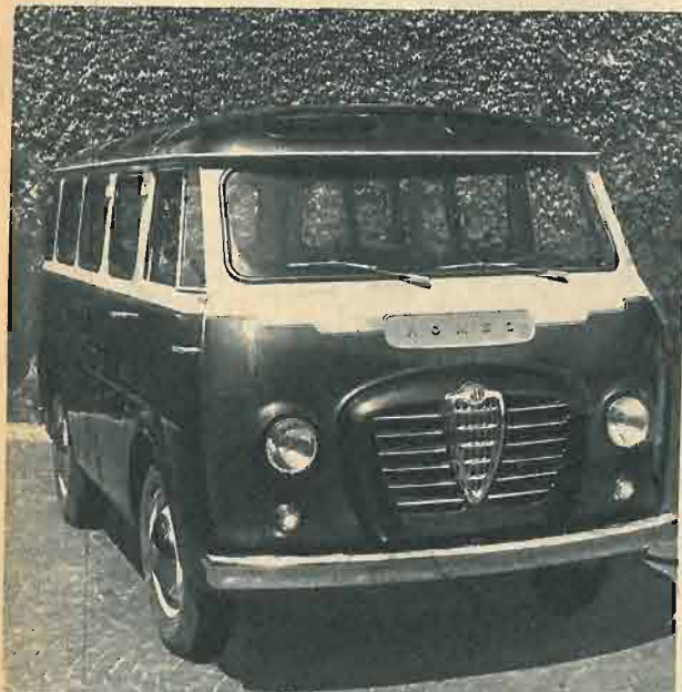
● Il ROMEO, nella versione autobus, può trasportare 10 persone. Può essere dotato di un motore diesel a 2 tempi (1158 cc di cilindrata) ovvero di un motore a benzina a 4 tempi (1290 cc).
