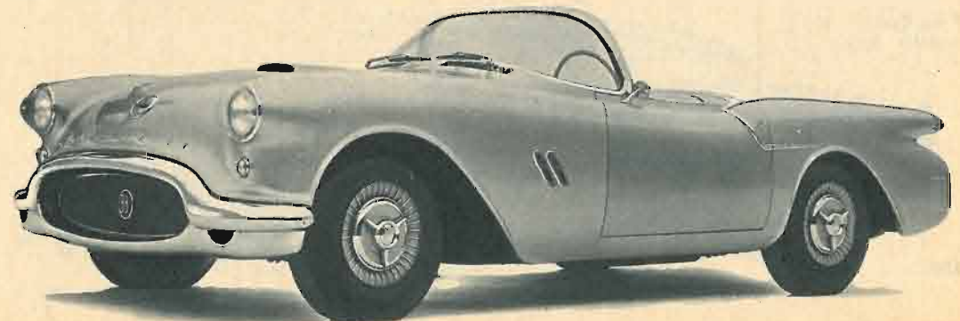
● Un altro veicolo sperimentale costruito dalla General Motors: la BUICK WILDCAT. Il motore, un V 8 come il Rocket della Oldsmobile, eroga 220 cav. Si noti, anche in questa macchina, l'impiego del parabrezza panoramico. La linea della
