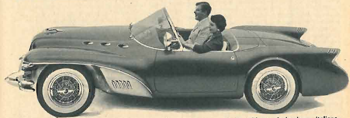
● Un altro veicolo sperimentale costruito dalla General Motors: la BUICK WILDCAT. Il motore, un V 8 come il Rocket della Oldsmobile, eroga 220 cav. Si noti, anche in questa macchina, l'impiego del parabrezza panoramico. La linea della
